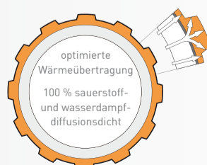
VarioProFil-Rohr 16 x 2 Laser 5-Schicht-Verbundrohr
